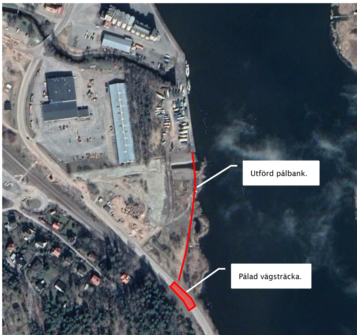
Figur 3. Översiktligt läge och omfattning av befintliga förstärkningsåtgärder.
